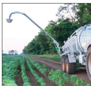
Вращение и подъем при помощи гидроцилиндра.
