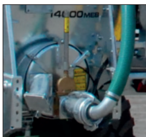
Соединение с заслонкой и быстрая установка разбрызгивателя.
